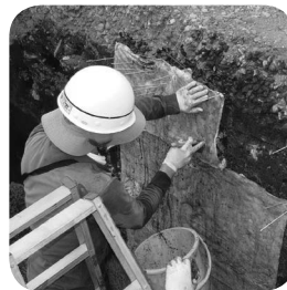
3. 樹脂と裏打ち布を土層に密着させる。
